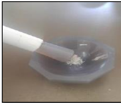
شکل ۸- ساییدن پودر کوارتز
