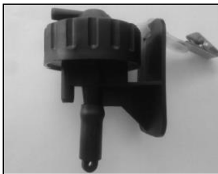
شکل ۶-سیکلون جهت نمونه‌برداری از ذرات قابل استنشاق
